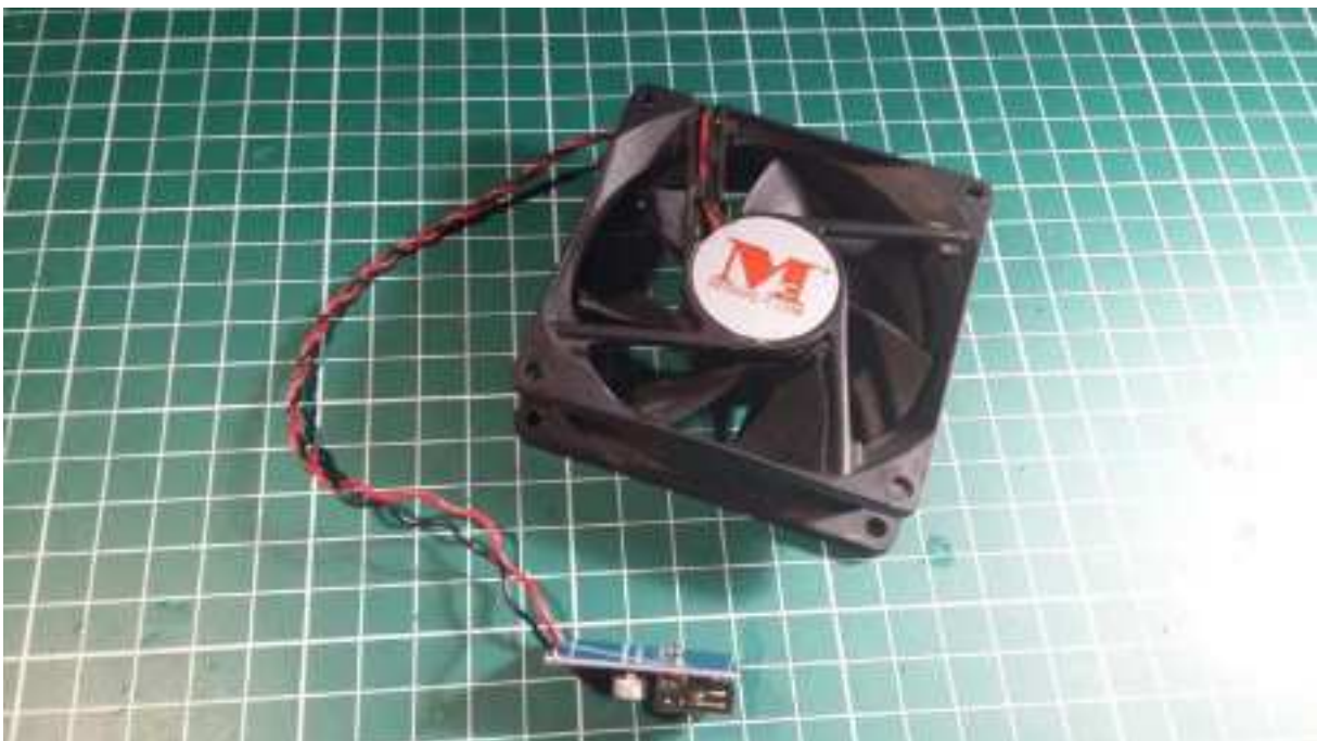
Fot. 43. Wentylator z przylutowaną przetwornicą step-up
