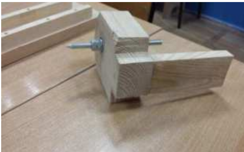
Fot. 34. Na dole konika należy zamocować deseczkę odpowiadającą szerokości prowadnic
