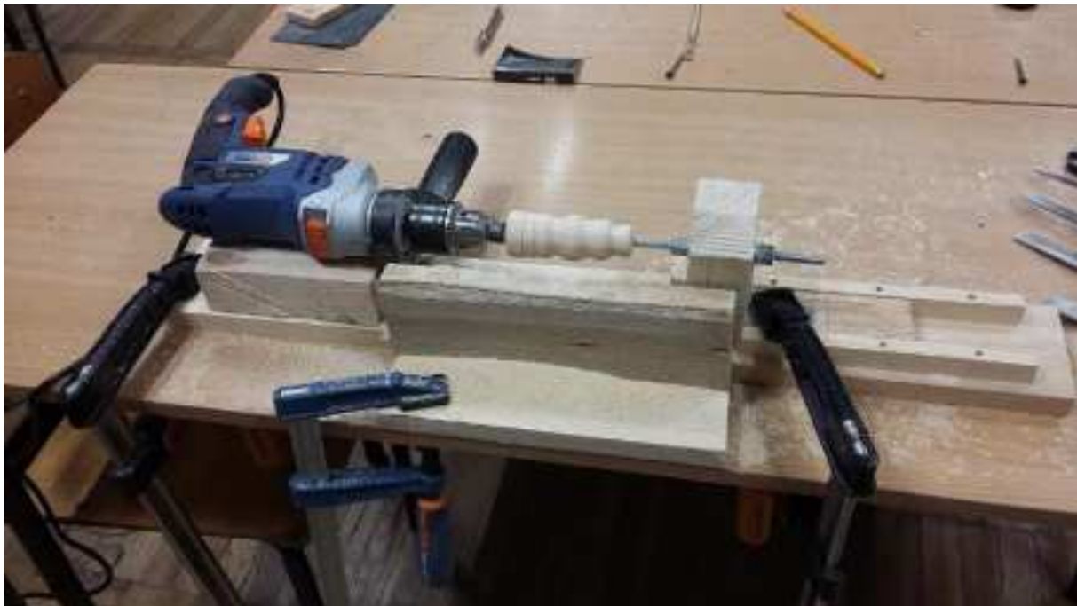
Fot.39 Suport musi być zamocowany jak najbliżej toczzonego materiału.
