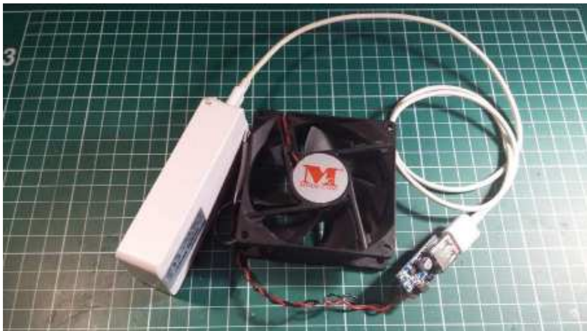
Fot. 41. Działający model wiatrowni. Tutaj zamiast telefonu wpięty jest power bank.
