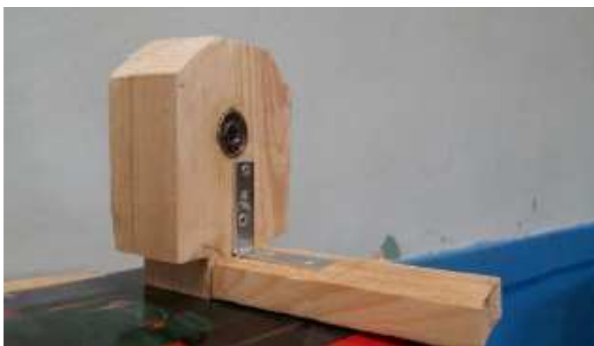
Fot. 35. Konik – metalowy kątownik wzmacniający konstrukcję
