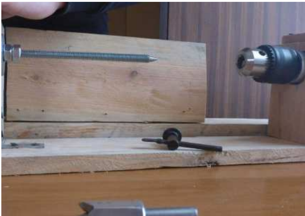
Fot.25. Ustawianie kła i uchwyty wiertarskiego w osi
